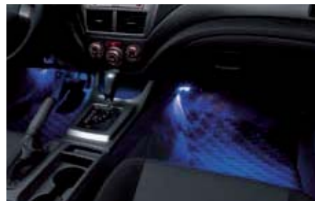
58 Fussraumbeleuchtung H7010SC000 ★W Schaltet sich beim Öffnen oder Schliessen der Vordertür automatisch ein und beleuchtet den Fussraum. Erleichtert das Ein- und Aussteigen im Dunkeln. *Montage-Kit dazubestellen
