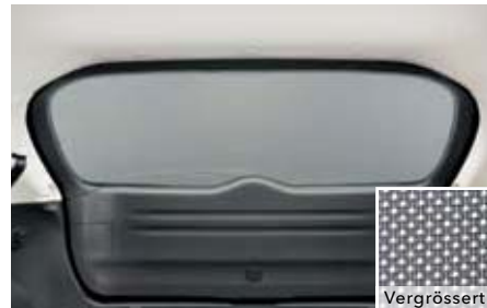
46 Sonnenschutz (Heckscheibe) F505EFG000 ★ W Zum Schutz des Laderaumes vor starker Sonneneinstrahlung von hinten. Durchsichtige Maschenstruktur.
