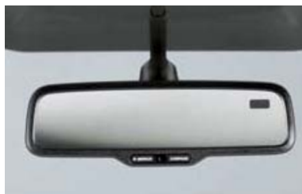
65 Innenspiegel H501SFG000 ★W Dunkelt bei Lichteinfall von hinten automatisch ab. Enthält einen elektronischen Kompass *Montagekit dazubestellen
